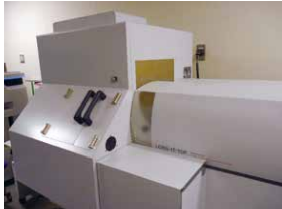
島津製作所と共同で瀬藤が開発した質量顕微鏡プロトタイプ
